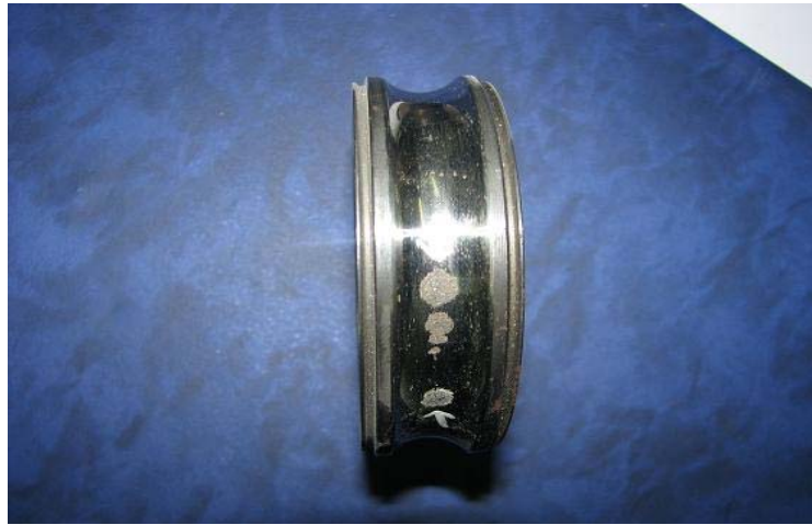
شکل ۶- تصویر رینگ داخلی (Inner Race) آسیب دیده بیرینگ.
