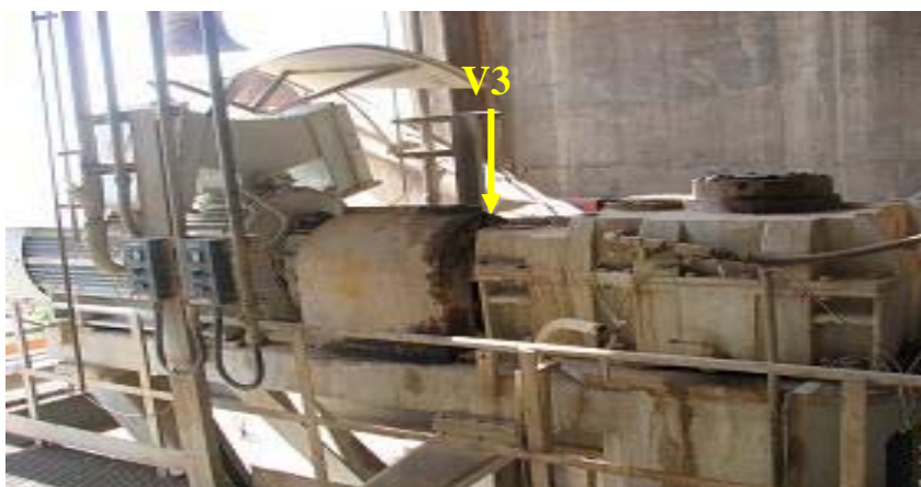
شکل ۷- تصویر گیربکس رآکتور و راستای داده برداری V3.
