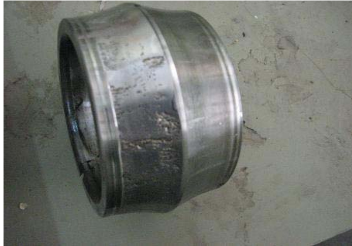
شکل ۲۱- آثار خرابی روی رینگ داخلی (Inner Race) بیرینگ .
